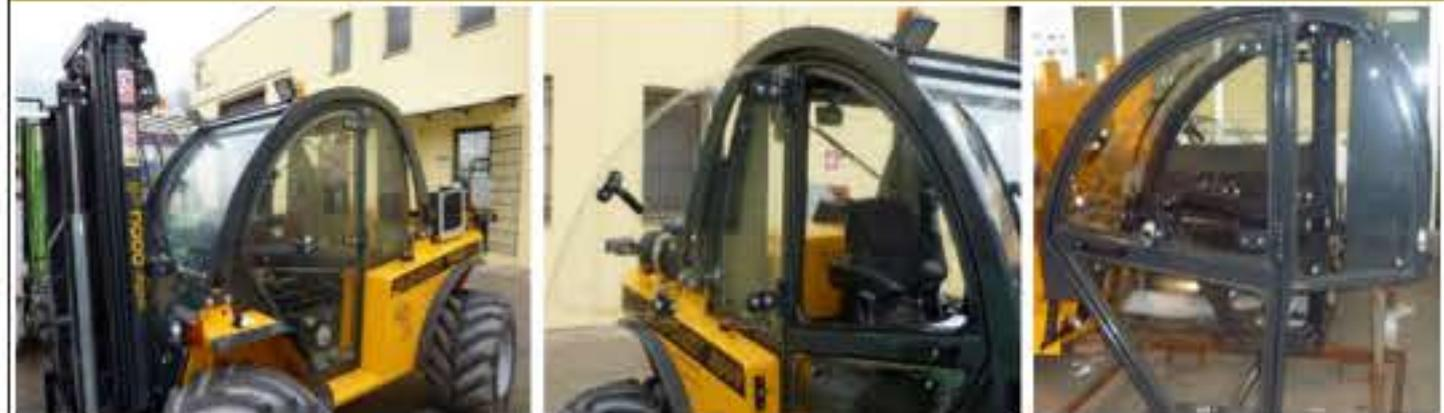
Les chariots élévateurs **Elephant 2500 et 3000** peuvent être équipés d'une **cabine** à haute visibilité construite en verre trempé, sur structure en acier. Grâce à cette cabine qui peut aussi être montée après l'achat du chariot, l'opérateur peut travailler très confortablement même dans de mauvaises conditions climatiques. La **cabine** est disponible dans la version base, avec chauffage et climatiseur.
